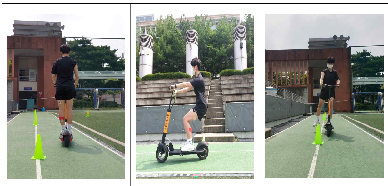
그림 11. 자세별 EMG 측정 사진(선자세, 앉은자세, 외발자세)
